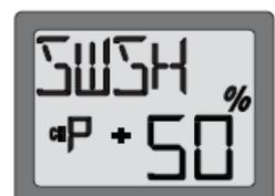
4. Selecione outros canais (profundor e passo) usando a tecla SELECT para ajustar a direção e a quantidade de movimento do servo da mesma maneira que foi ajustado o canal do aileron.
