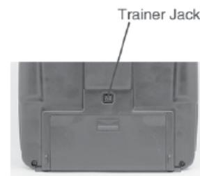
5. Com o rádio desligado, conecte o cabo trainer nos dois rádios. (No modelo 6EX-2.4GHz o conector trainer está no centro da parte traseira do rádio. Não force o encaixe do trainer, note que o plug encaixa somente em uma posição).
