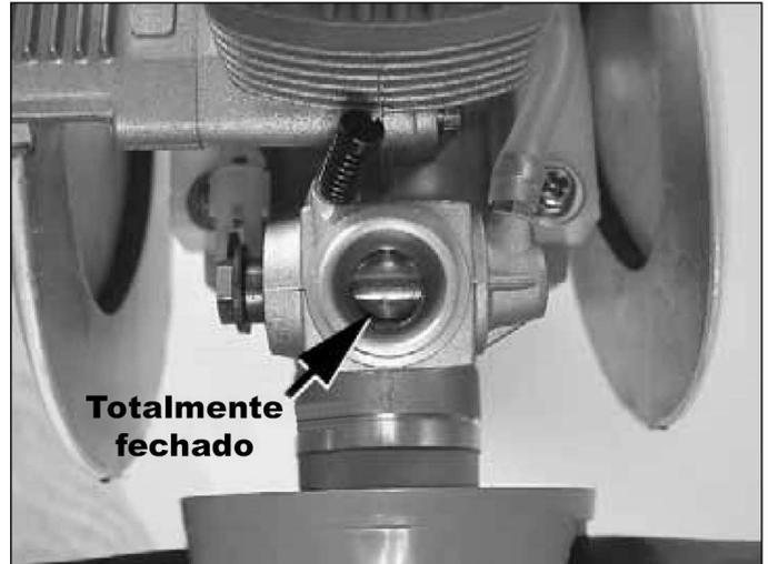
2. Observe a abertura no carburador. Se o carburador estiver totalmente fechado, prossiga para o passo 3. Se o carburador estiver quase, mas não totalmente fechado, desaperte o parafuso do braço do servo do acelerador e mova a haste de comando para trás até que o carburador esteja fechado. Aperte com segurança o parafuso.
