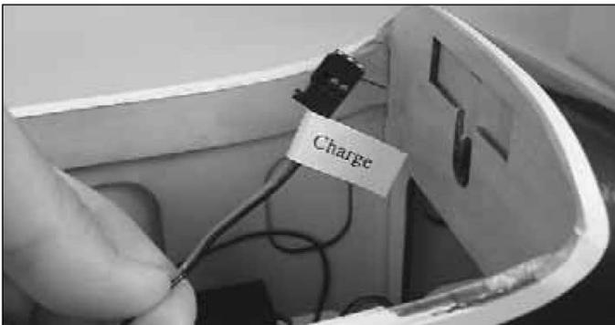
2. As baterias devem ser totalmente carregadas antes do uso. Se você planeja montar o avião agora, as baterias podem ser carregadas depois. Se você planeja montar o avião depois, carregue as baterias seguindo as instruções no manual fornecido para o sistema de controle do rádio. Observação: Quando carregar a bateria do receptor, conecte o carregador ao plug etiquetado como "Charge" dentro da fuselagem.
