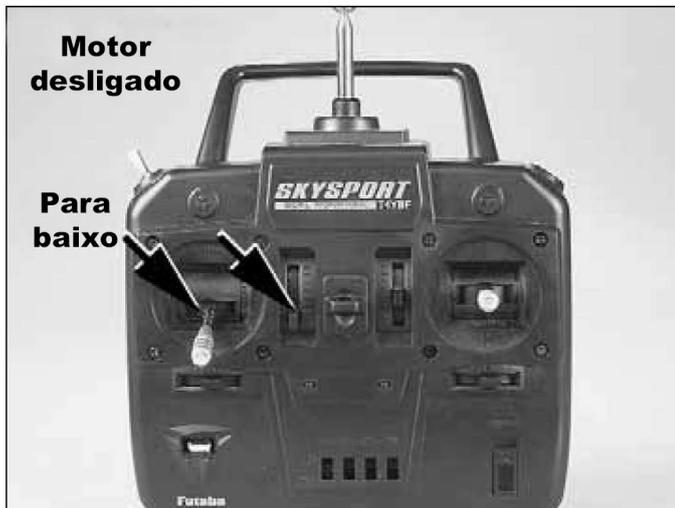
1. Com o transmissor e o receptor ligados, mova a alavanca de ajuste fino do acelerador e a alavanca do acelerador totalmente para baixo.
