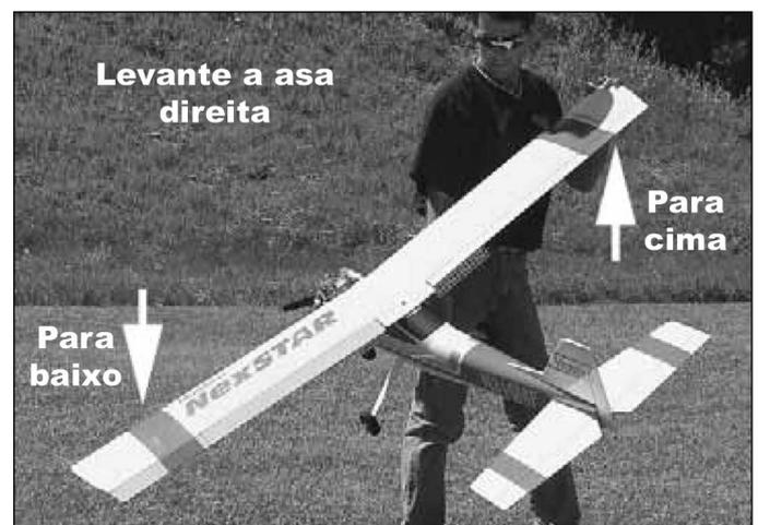
4. Com o avião nivelado, vire a asa direita para cima. O aileron direito deverá se mover para cima e o aileron esquerdo deverá se mover para baixo.
