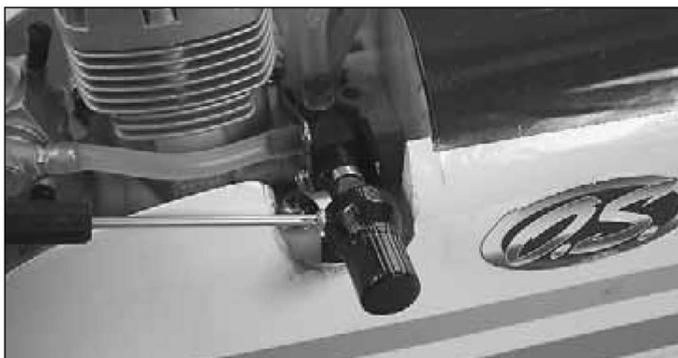
Remova o parafuso que prende o limitador no lugar e remova o mesmo. Ajuste a agulha de alta rotação para a regulagem de mistura mais pobre desejada.
