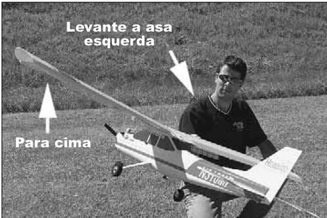
5. Com o avião nivelado, vire a asa esquerda para cima. O aileron esquerdo deverá se mover para cima e o aileron direito deverá se mover para baixo.
