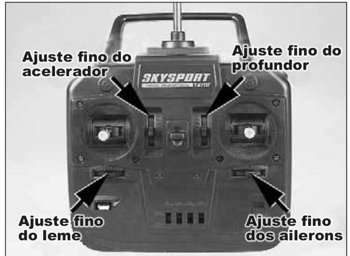
2. Ligue o transmissor e o receptor. Alinhe todas as alavancas de ajuste fino (trimers) no transmissor. Examine o compartimento de rádio e assegure-se que os braços dos servos do leme de direção e do profundor estão perpendiculares às laterais da fuselagem tal, como se vê na imagem abaixo. Se necessário, desaparafuse os braços dos servos e alinhe-os como mostrado na imagem abaixo. Lembre-se de recolocar o parafuso.
