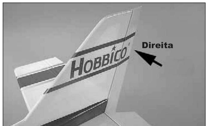
3. Mova a alavanca esquerda para a direita e observe o leme de direção. Mover a alavanca para a direita deverá fazer o leme de direção (e a roda do nariz) se mover para a direita. Se necessário, use as chaves de inversão sobre o transmissor para fazer o leme de direção responder na direção correta.
