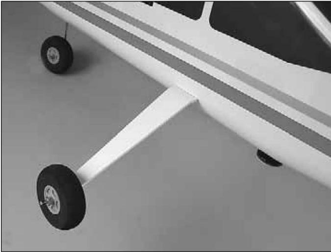
2. Instale a outra perna do trem de pouso no outro lado da fuselagem da mesma forma. Uma vez que ambas estejam instaladas, aplique um pouco de força para puxá-las para fora. Você não deverá conseguir retirá-las. Se elas saírem, então empurre-as novamente para dentro até que elas estejam devidamente encaixadas.
