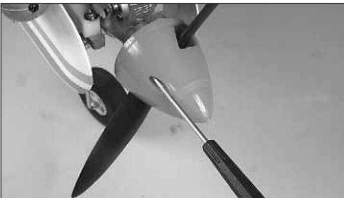
3. Encaixe o cone na placa traseira e, então, use uma chave Phillips para apertar os parafusos até um ponto confortável, sem exagerar na força.
