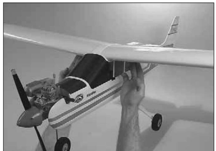
3. Monte a asa na fuselagem. Levante o modelo pelos dois lados da fuselagem com as pontas dos dedos entre as duas linhas na face inferior da asa.
