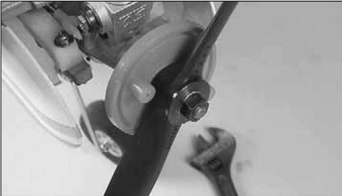
1. Retire o cone da hélice. Remova a porca e a arruela da hélice. Instale a hélice nova; recoloca a arruela e a porca no eixo do virabrequim.
